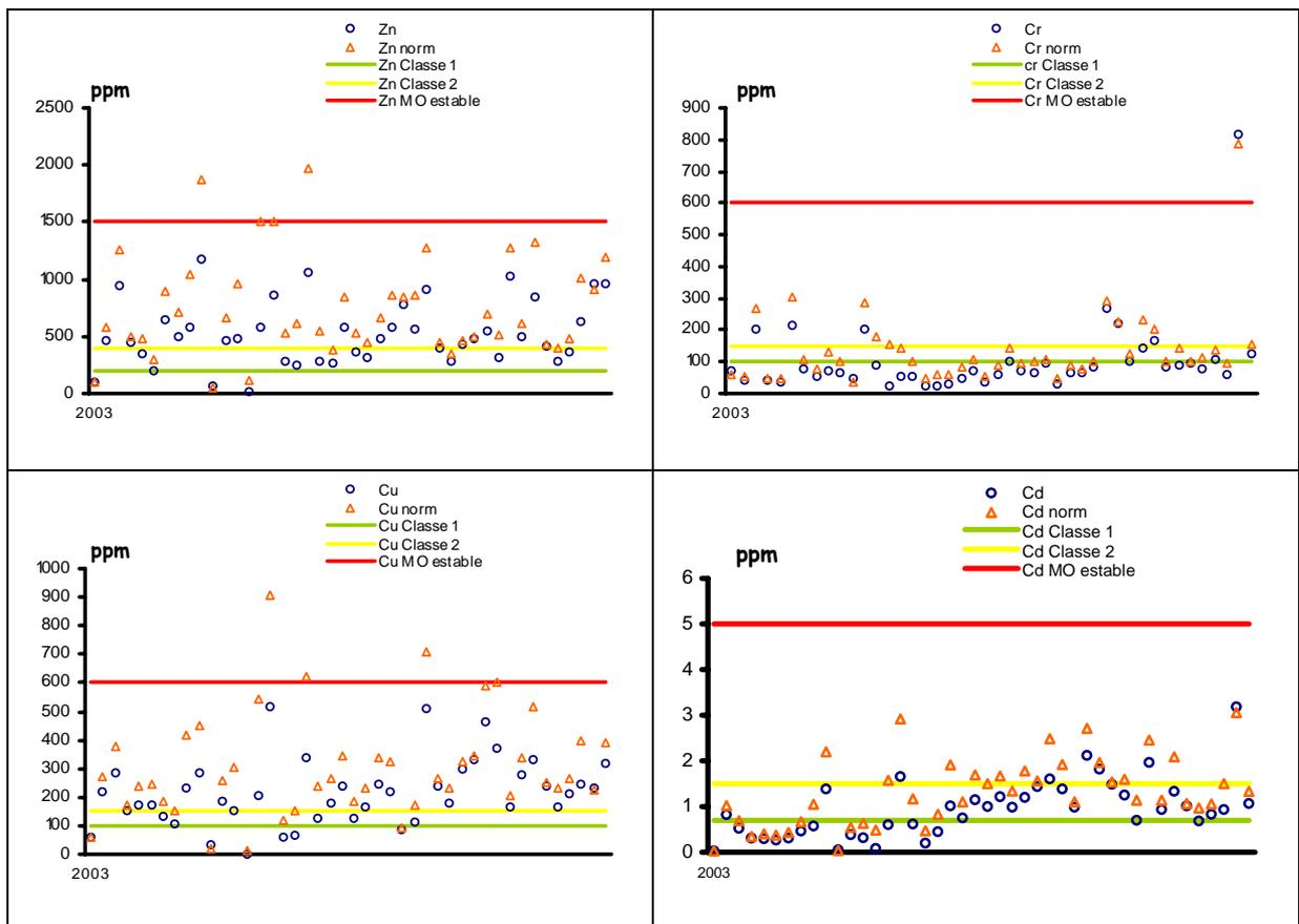
Figura 5. Contenido en metales pesados de muestras de compost de FORM expresadas sms y smh pero con el contenido en MO normalizado al 30% [17] comparados con los niveles propuestos en el borrador de la UE [20].
